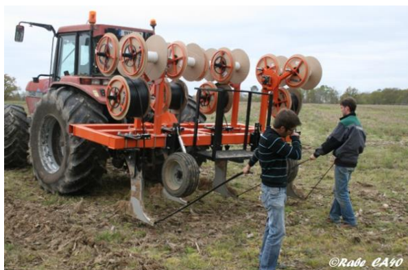
Figure 5: Implantation de goutte-à-goutte avec sous-soleur (Rabe, CA40, 2012-2020).
