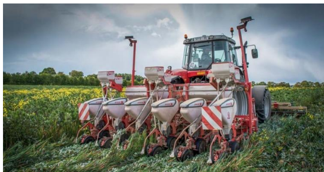
Figure 3 : Semis Direct sous couvert végétal (Plateforme Triple performance).
