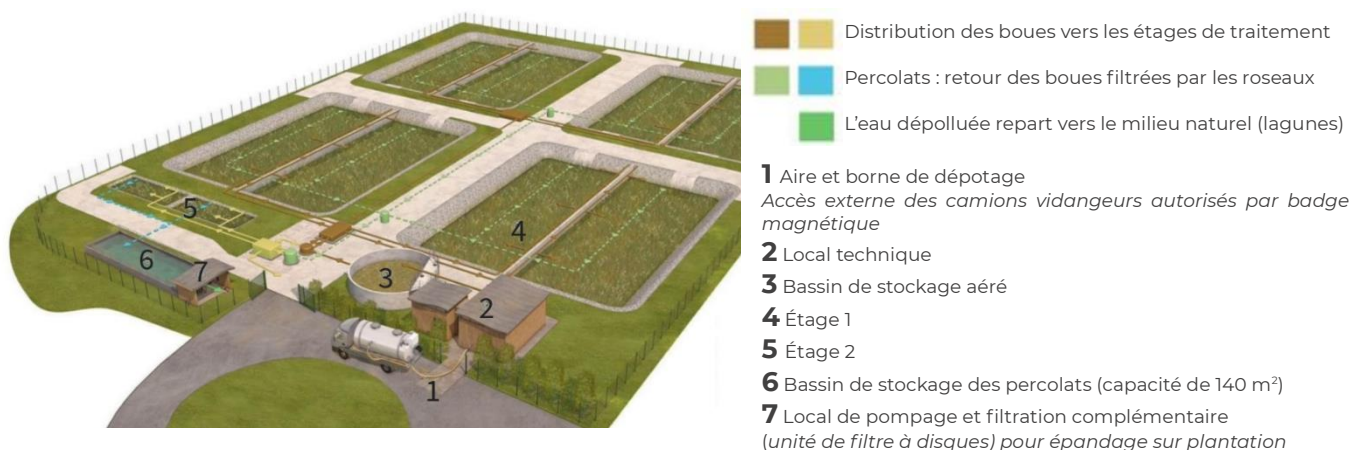
Figure 2 : Photos et schéma des différentes étapes de traitement des matières de vidange de l'unité de Nègrepelisse (Irstea et al., 2018.)
